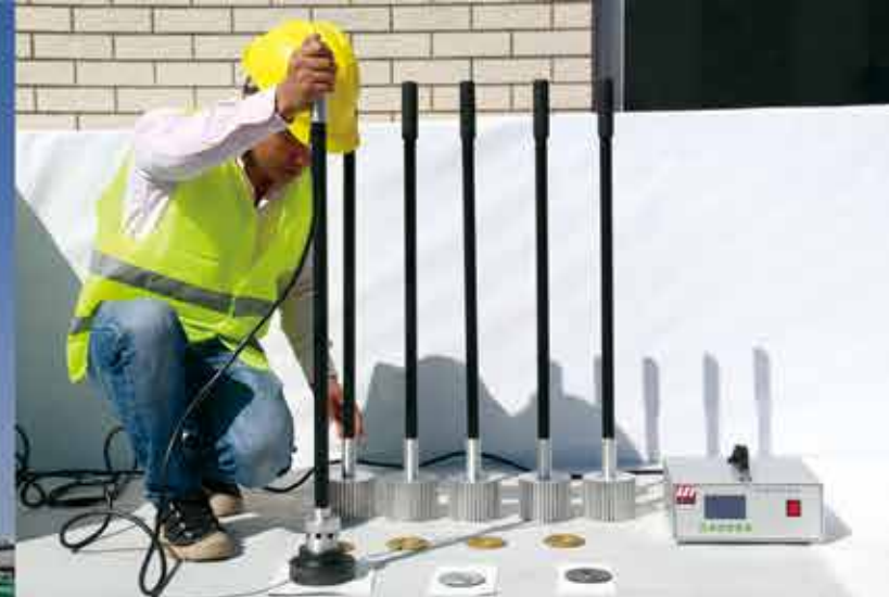
▲ 磁焊机实现卷材和紧固垫片无穿孔焊接 LST-REW
